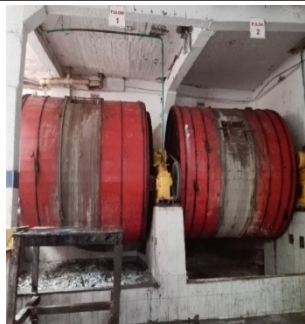
Foto No.4 bombos de pelambre
